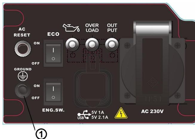
O terminal de terra (terra) ① liga a linha de terra para evitar choques elétricos. Quando o dispositivo elétrico está ligado à terra, o gerador tem de estar sempre ligado à terra.
